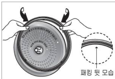
⑤ 분리형커버에 패킹을 장착시킬 경우 패킹 뒷부분의 홈에 가장자리를 끼운 후 한바퀴 돌리면서 장착합니다.
